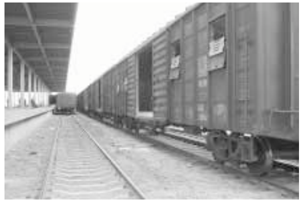
写真9 バラ荷の積み替え場。左が広軌、右が標準軌
